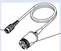
Vier Steckplätze für austauschbare Sensoren ermöglichen gleichzeitiges Messen von Temperatur/Leitfähigkeit und gelöstem Sauerstoff sowie zwei ionenselektiven Parametern wie pH, Redox, Ammonium, Nitrat und Chlorid. Wird ein Anschluss nicht genutzt, verschließen Sie ihn einfach mit einem Blindstopfen.
